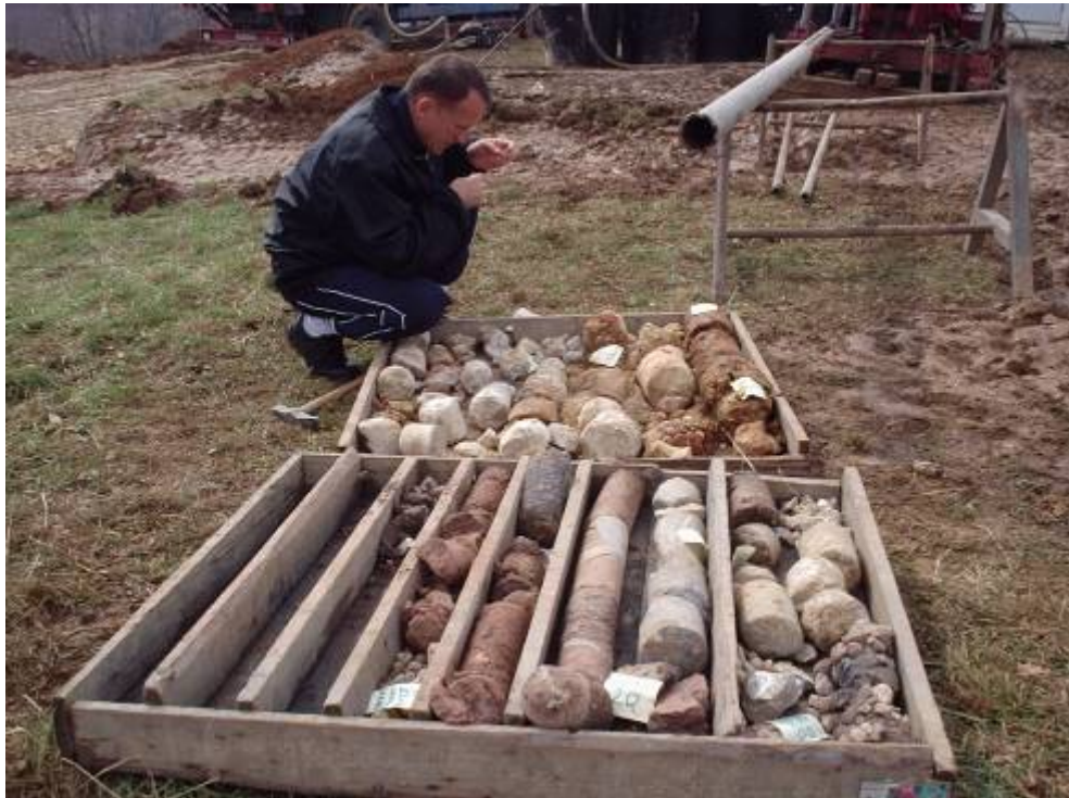
Slika br. 14 Kartiranje nabušenog jezgra istražne bušotine B-3 Teočak
