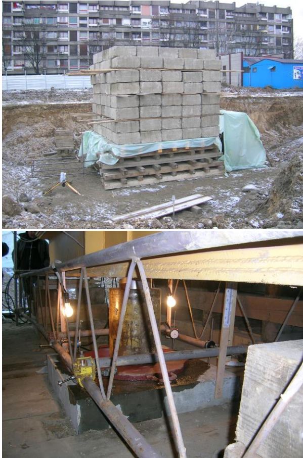
Slika 9. Probno opterećenje šipa hidrauličkom presom
