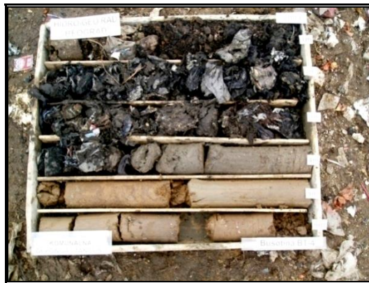
Slika 1 – Nabušeno jezgro iz komunalne deponije „Tancoš“ u Beočinu (foto: M. Rakijaš, 2012)
