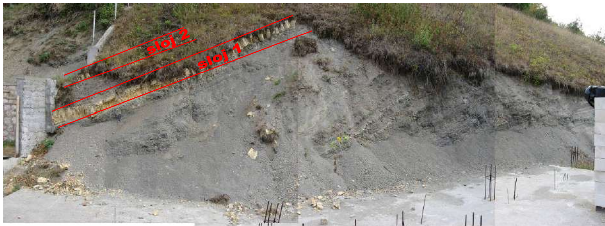
Sl. 2. – Laporci sa slojevima tufa. sloj1- 20cm tuf pepeljasto sive do žute boje, sloj 2- 10cm tuf, svijetlo žute boje sa kvarcnim pijeskom (foto T.Nikolić, 2012.)
