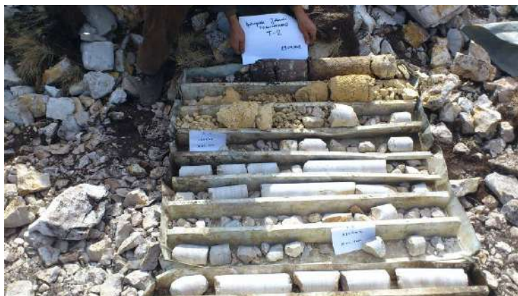
Slika 12. Jezgro geomehničke bušotine izvedene za vjetroagregat V2
