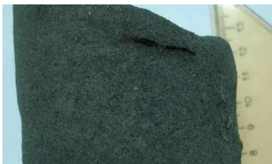
Slika 5. Silikatni pješčar iz bušotine IHB-1 sa 325 m gdje se u gornjem dijelu vidi lamina uglja debljine oko 2 mm sa padnim uglom 12 stepeni (desno je centimetarsko mjerilo)
