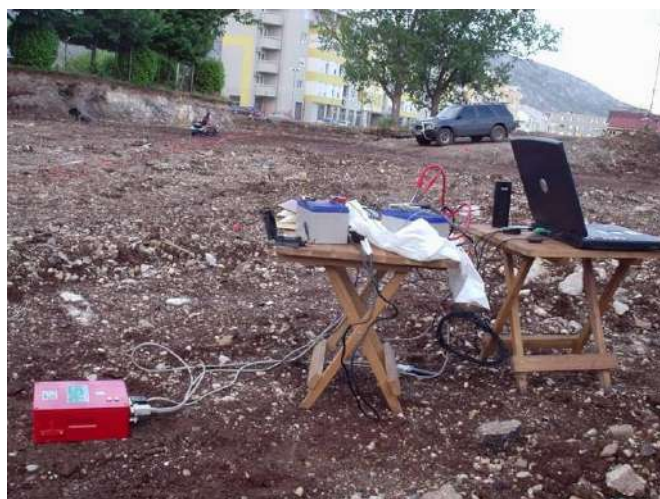
Slika 13 Mjerenje mikrosezmičkog nemira
