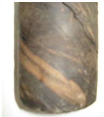
Slika 2. Jezgro crnog lignita sa svijetlim slojem debljine oko 1,5 cm koji ima padni ugao oko 30 stepeni i sačuvanu drvenastu strukturu
