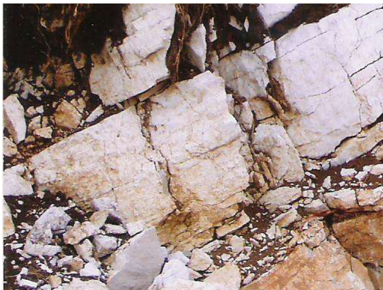
Slika 3. Sivo bijeli slojeviti krečnjaci sa prslinama i pukotinama koje su upravne i paralelene na slojevitost
