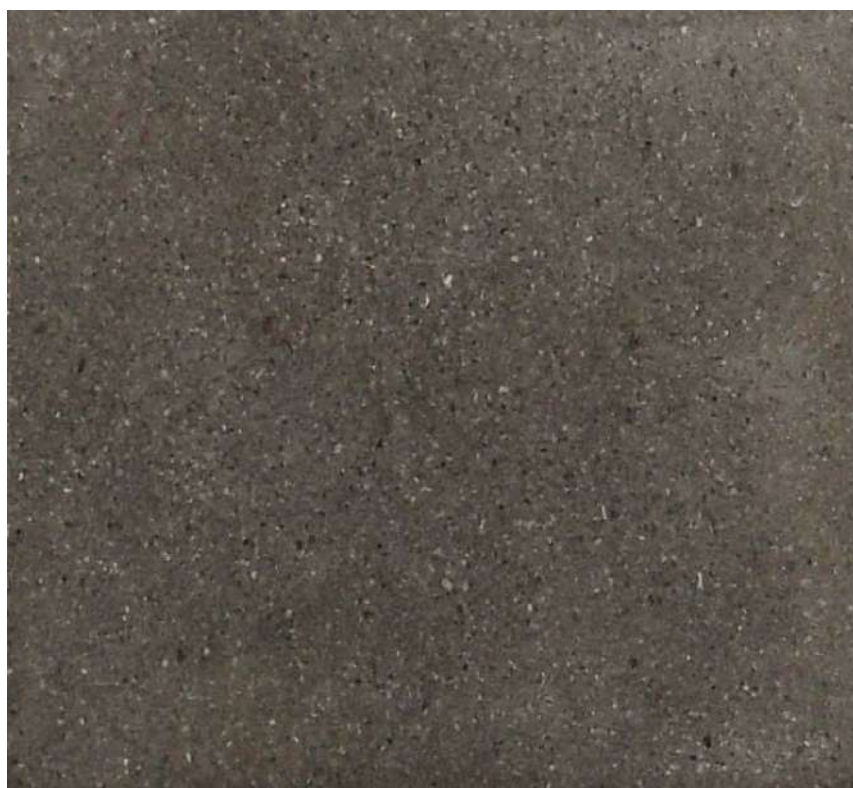
Sl. 9 Izgled ispoliranog uzorka kalkarenita sa lokaliteta Grabež
