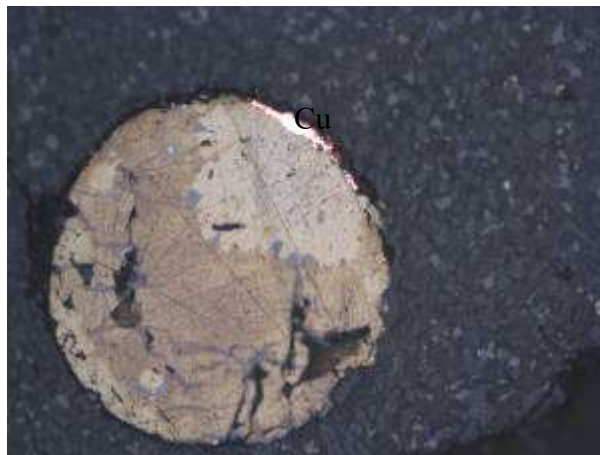
Slika 21. Žilice elementarnog bakra (Cu), II N, 500X
