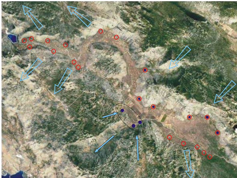
Sl.5 . Satelitski snimak sa generaliziranim prikazom tečenja podzemnih voda
