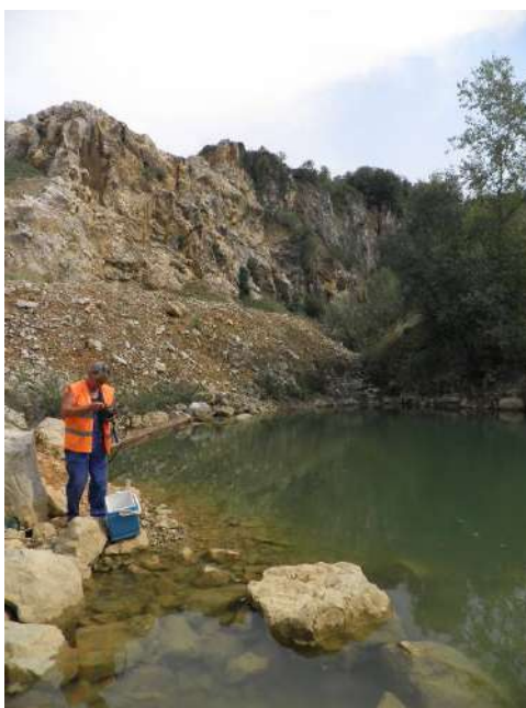
Slika br. 4: Uzimanje uzorka vode sa vodene površine u blizini deponije
