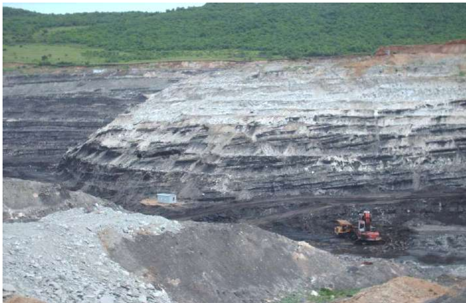
Sl.3. Gornji dio ugljenog sloja sa neposrednom povlatom na PK "Dimnjače" (središnji dio ležišta)
