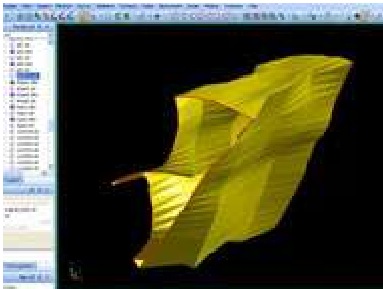
Slika 5. 3D model ležišta u programu Surpac
