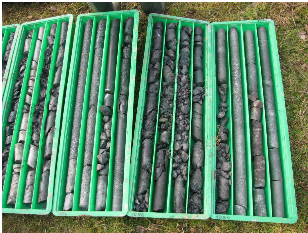
Slika 4. Jezgro bušotine DH-1 sa dubine 1078 do 1094 m.
