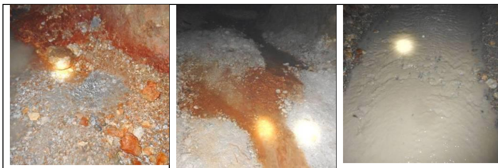
Слика 4. Појаве истицања подземних вода на хоризонту -222 са протицајем од 0,1 до 1 l/s и температуром од 25,4 до 27°C
