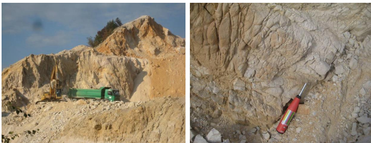
Slika 4 – a) Transport grusifiranog dolomita; b) intenzivna ispucalost dolomita
