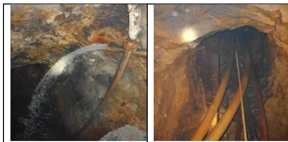
Слика 6. Препумпавање рудничких вода са једног хоризонта на други
