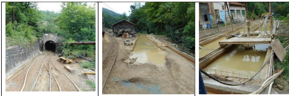
Слика 11. Таложни базени за испумпану воду из јаме
